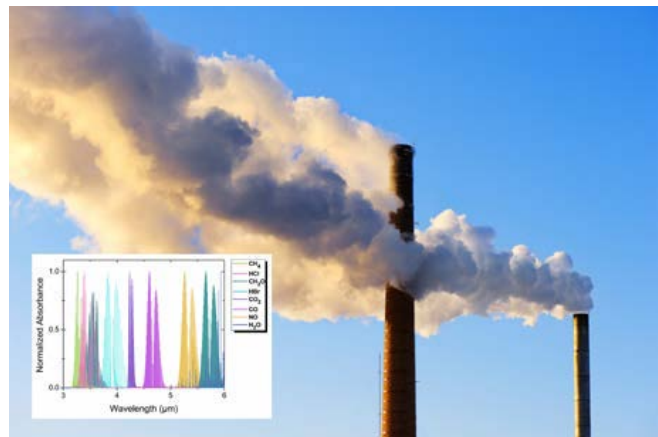
Bild 2: Spektroskopische Fingerabdrücke von Gasen, die bei industriellen Verbrennungsprozessen entstehen (Quelle: nanoplus GmbH)
