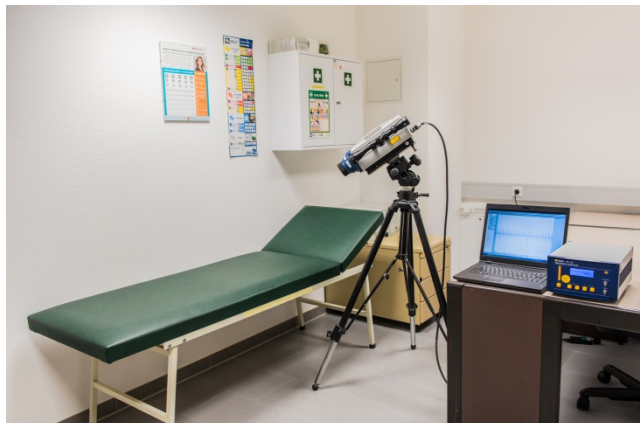
Bild 2: Versuchsaufbau für die Voruntersuchungen mit einem Laservibrometer (Quelle: Polytec GmbH, Waldbronn)
